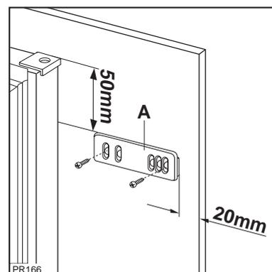
7. Приложите направляющую (A) на внутреннюю сторону двери шкафа, сверху и снизу, как показано на рисунке, и отметьте положение крайних отверстий. Подготовив отверстия, установите направляющую при помощи входящих в комплект винтов.
