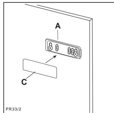
8. Установите и защелкните крышку (C) на направляющей (A).
