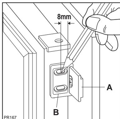
9. Откройте дверь морозильника и шкафа приблизительно на 90°. Вставьте кронштейн (B) в направляющую (A). Удерживайте двери прибора и шкафа вместе и отметьте отверстия, как показано на рисунке. Снимите кронштейны и просверлите отверстия диаметром 2 мм на расстоянии 8 мм от наружной кромки двери. Вновь установите кронштейн на направляющую и закрепите входящими в комплект винтами.
