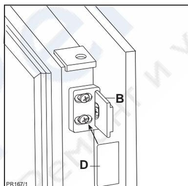
11. Установите и защелкните крышку (D) на направляющей (B).
