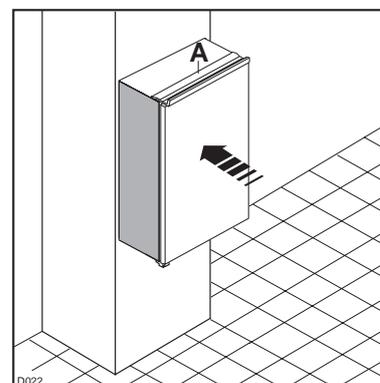
2. Вставить прибор в проём до тех пор, пока верхний стопор (A) не упрётся в панель мебели.
