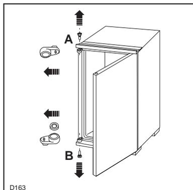
Для перевозки дверь прибора закреплена специальными осями. Удалите верхнюю и нижнюю ось согласно направлению открывания двери.
