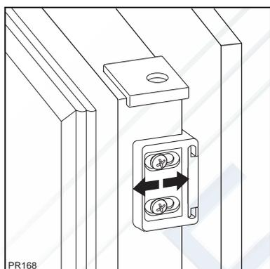
10. Для выравнивания двери шкафа пользуйтесь регулировочными прорезями. Выполнив эти операции, необходимо проверить плотность закрытия двери прибора.
