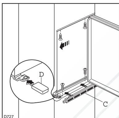
4. Приблизить прибор к боковине мебели, противоположной петлям. Закрепить прибор имеющимися 4 винтами. Установить вентиляционную решётку (C) и накладку петель (D), защёлкнув их.
